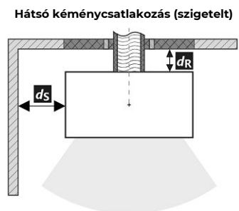
A füstcső áthaladása éghető anyagból készült falon
